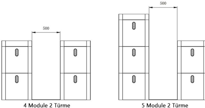
Abbildung 1: Batteriepack-Konfigurationen
