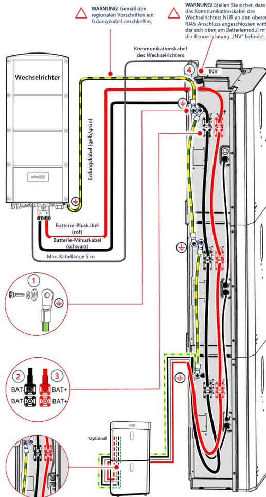
Abbildung 20: Anschließen der Kabel zwischen den Batteriemodulen
