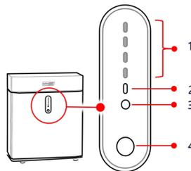
Abbildung 14: Batterie-LED-Anzeigen
