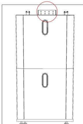
Abbildung 11: Installieren von Batteriemodulen in einer Turmkonfiguration
