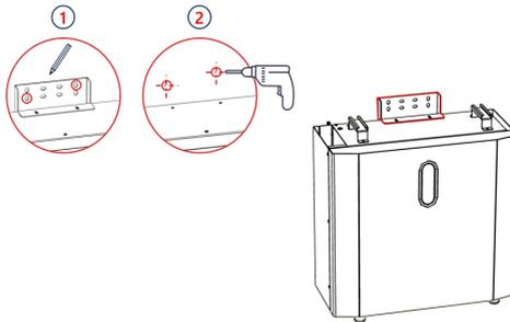
Abbildung 8: Bohren der Löcher für die Wandhalterung
