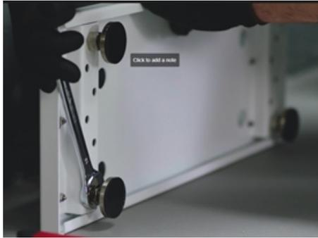
Abbildung 6: Bodenständer - Anziehen der Mutter
