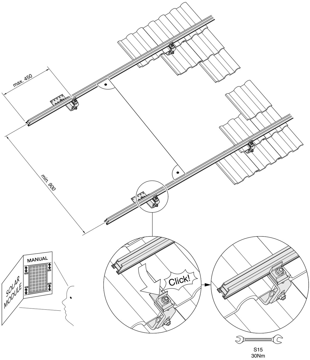
Modulmontage / Montage des modules / Montage van de modules
