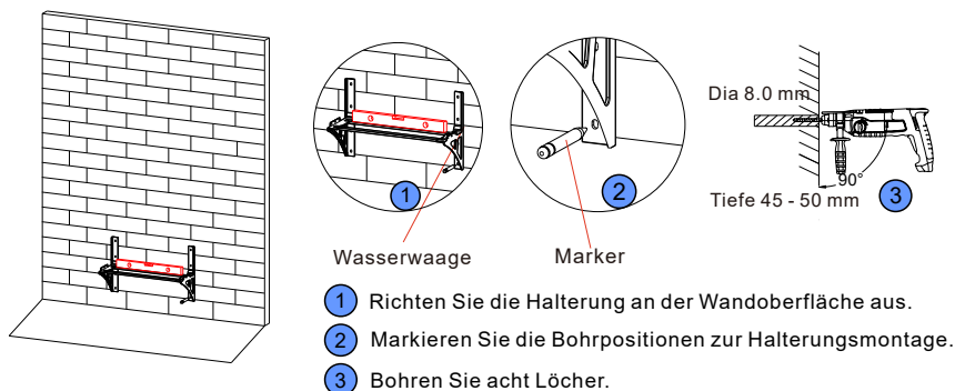
Abbildung 4-9: Bestimmung der Bohrpositionen für die Wandhalterung
