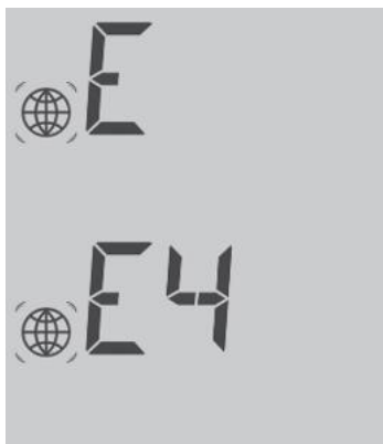
Abb.: Beispiel Blinkcodes für Internet - Fehler 4
