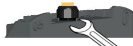
Abb. 6-15: Kabelverschraubung von der Rückseite festziehen
